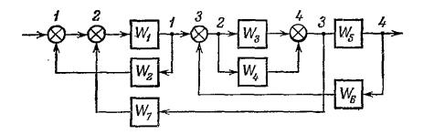
Вначале сумматор 1 (см. рис.) переносится вправо через сумматор 2, определяется передаточная функция встречно-параллельного соединения линейных звеньев  $W_1$  и  $W_2$ :
