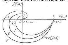
Для использования изложенного приема применительно к астатическим системам, которые содержат интегрирующее звено, и амплитудно-фазовые характеристики которых начинаются в бесконечно удаленной точке, характеристику  $W(j\omega)$  предварительно дополняют дугой окружности бесконечно большого радиуса на угол  $\pi r/2$ , где r- степень астатизма системы (см. рис.)
