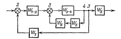
Затем рассчитывается передаточная функция встречно-параллельного соединения, в прямом канале которого находится  $W_{3-4}$ , а в обратной связи — последовательное соединение звеньев  $W_5$  и  $W_6$ :
