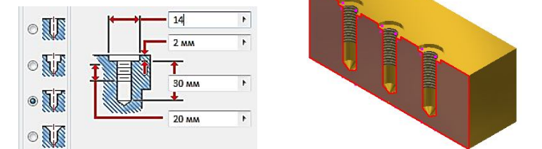
Рис. 2.40. Резьбовое отверстие с местом под уплотнение
