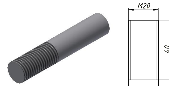
Рис. 2.5. Резьба на 3D-модели стержня и полученный по ней чертеж
