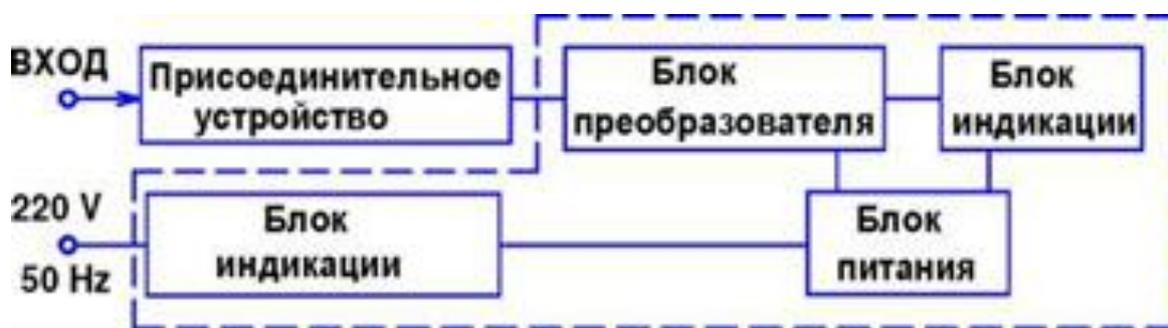
Рис. 4.4 Структурная схема измерителя ЦР-0200
