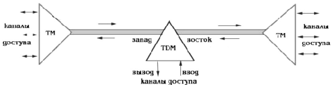
Рис. 1.2 Топология "последовательная линейная цепь", реализованная на TM и TDM
