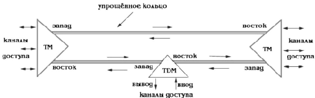
Рис. 1.3 Топология "последовательная линейная цепь" типа "упрощённое кольцо" с защитой 1+1
