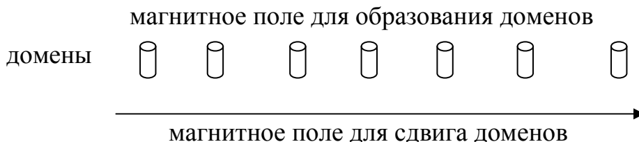
Рис. 8.6 – Принцип формирования памяти на ЦМД
