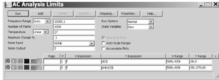
Рис. 5.14 — Установки в окне AC Analysis Limits при моделировании резонансного усилителя в частотной области
